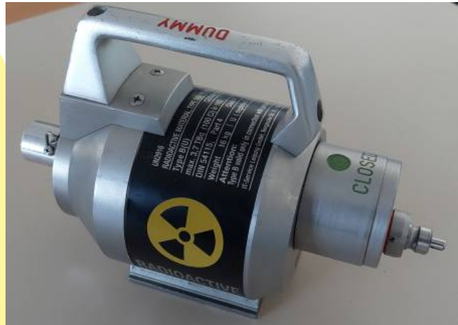
Gamma-Arbeitsgerät ohne Strahlerführung und Fernbedienung (Handkurbel)
