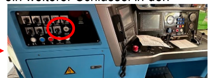
Aktivierung Führerraum Schloss im Führerpult 1
