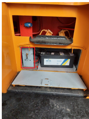
Abb.1: Batterie Hauptschalter (senkrechte Stellung-AUS)
