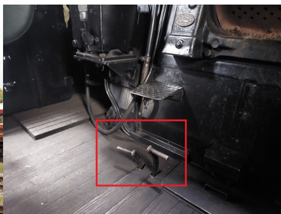
Abb.1.: Betätigung Luftklappen
