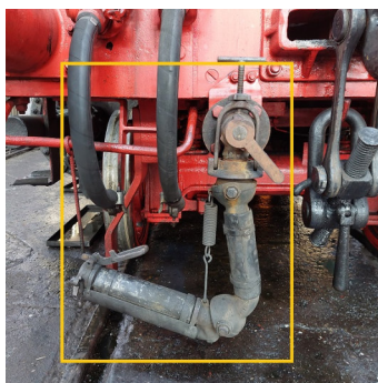
Abb.2 Dampfheizkupplung (an beiden Fahrzeugenden)
